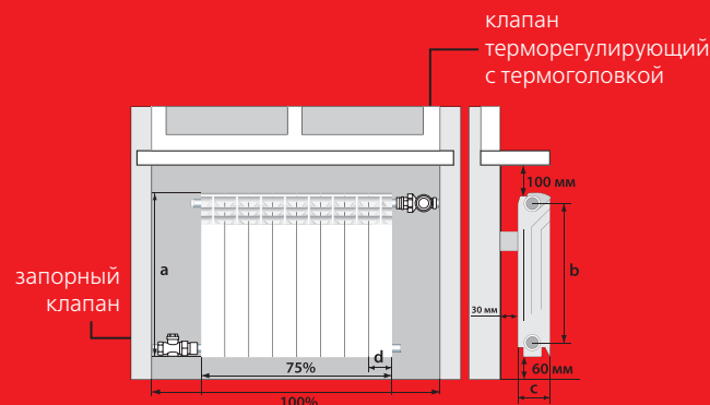
РИС. 2. РЕКОМЕНДУЕМЫЕ СХЕМЫ ПОДКЛЮЧЕНИЯ РАДИАТОРА К СИСТЕМЕ ОТОПЛЕНИЯ
