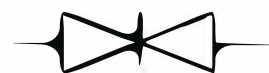
Вариант 3. Знак "Задвижка клиновидная или шиберная" Шаровой кран так обозначать неверно, но обозначают так часто.
