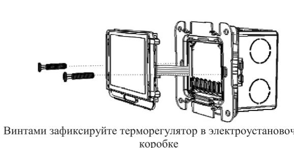
Винтами зафиксируйте терморегулятор в электроустановочной коробке
