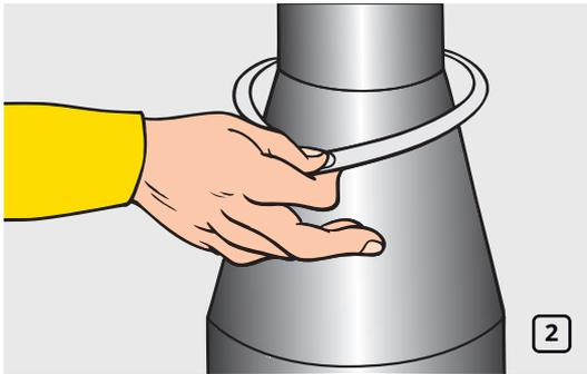
С помощью кронциркуля измерьте максимальный и минимальный диаметры сопрягаемых труб, добавьте двойную толщину листа K-FLEX к каждому из измерений (рис. 2).
