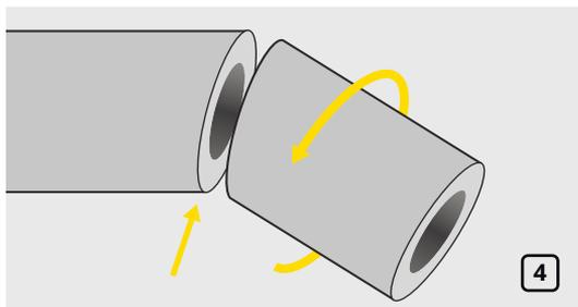
Развернуть одну часть трубки на 180° и соединить трубки (рис. 4).
