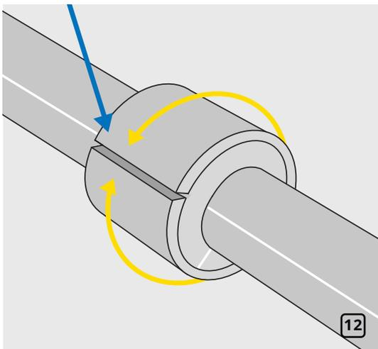
Нанесите клей на края полученного прямоугольника. Подождите пока клей подсохнет, оберните изоляционную полосу вокруг фланцев, соедините края материала, выполняйте работу от краев шва к его середине (рис. 12).
