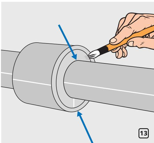
Проклейте места соединения двух изоляционных колец с муфтой, также с изоляцией на трубопроводе (рис. 13).
