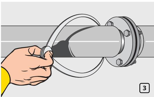
Измерьте диаметр трубы вместе с изоляцией (рис. 3).
