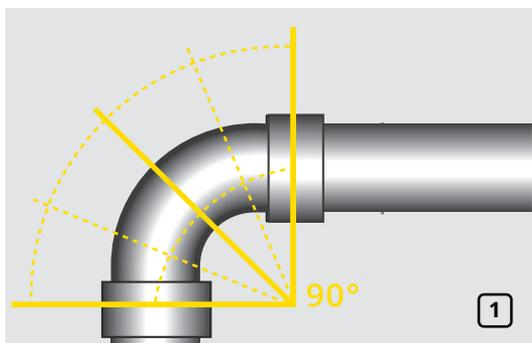
Для монтажа углов (отводов) 90° необходимо отрезать фрагмент теплоизоляционной трубки K-FLEX. Длина фрагмента должна быть равной сумме длин катетов, образующих внешний прямой угол отвода (рис. 1).
