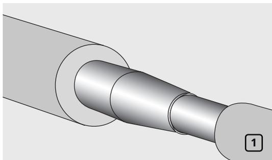
Выполните изоляцию основных труб, оставив неизолированной часть, примыкающую к переходу (рис. 1).
