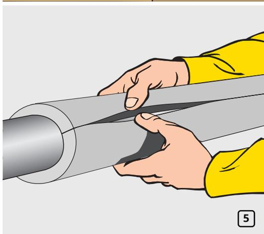
Как только клей подсохнет, оберните лист вокруг трубопровода. Соедините края материала и кратковременно их сожмите. Для избежания неравномерного соединения или растяжения материала, начинайте работу с концов монтируемого участка, затем переместитесь к его центру (рис. 5).
