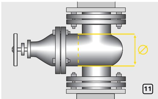
Измерьте диаметр горловины вентиля (рис. 11).
