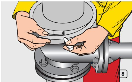
Определите длину окружности фланцев с помощью полоски материала той же толщины, что и применяемая изоляция, сделайте соответствующую пометку на ней (рис. 8).
