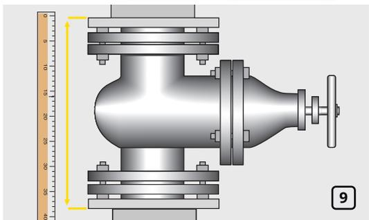
Измерьте расстояние между наружными поверхностями изоляционных колец, которые установлены на фланцах (рис. 9).
