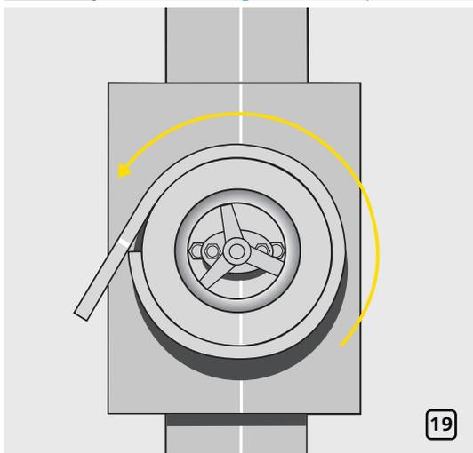
Измерьте длину окружности торцевого изоляционного диска с помощью полоски K-FLEX той же толщины (рис. 19).
