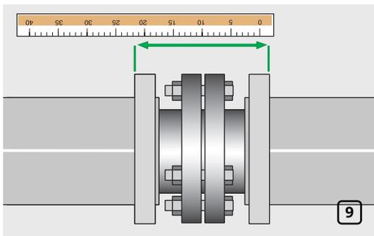
Измерьте расстояние между наружными поверхностями изоляционных колец, которые установлены на фланцах (рис. 9).
