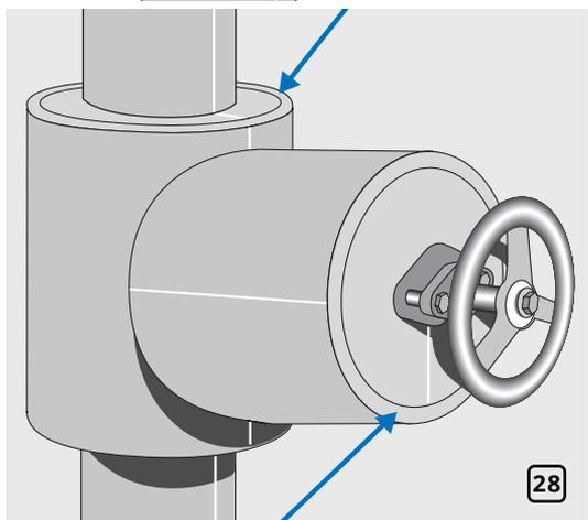
Склейте клеем K-FLEX K-404 места соединения изоляционных дисков всех фланцев с материалом покрытия вентиля и горловины (рис. 28).
