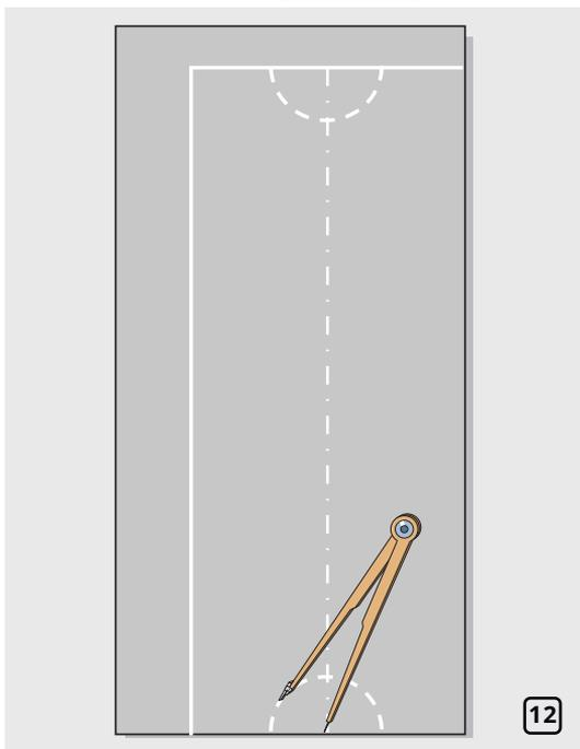
С помощью циркуля прочертите на краях прямоугольника два полукруга с радиусом равным радиусу горловины вентиля и центром на средней линии (рис. 12).
