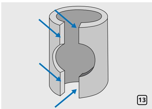
Ровно вырежьте полученную деталь по контуру. Нанесите клей на соединяемые края (рис. 13).
