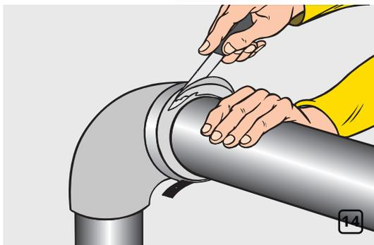
Зафиксируйте изоляцию металлическим ободом и подрежьте концы получившейся угловой секции (рис. 14).
