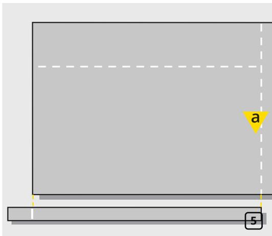
Измерьте длину окружности бокового ответвления используя полоску материала K-FLEX той же толщины, что и применяемая изоляция, определите необходимую длину изоляции отвода. Нанесите полученные размеры на изоляционный лист K-FLEX как показано на рисунке. Вырежьте выкройку по разметке длины окружности (а) (рис. 5).
