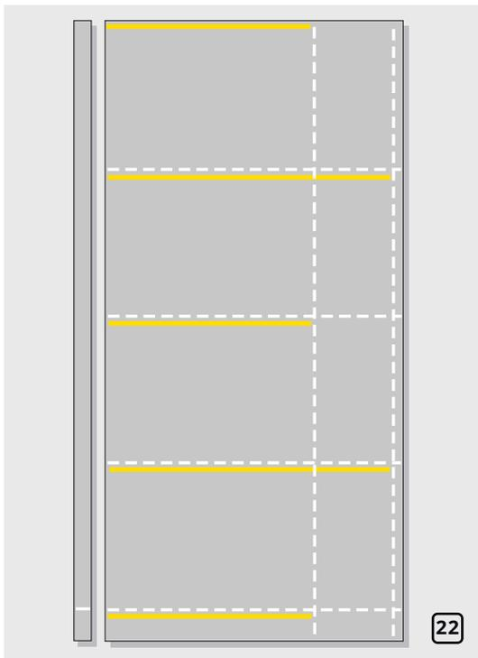
Отметьте на линиях разметки отрезки, длиной равной минимальной и максимальной глубине горловины вентиля как показано на рисунке (рис. 22).
