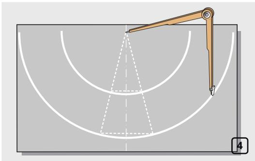
С помощью циркуля проведите из точки пересечения прямых две дуги через концы отрезков с измерениями диаметров (рис. 4).
