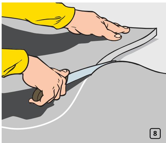
Аккуратно отрежьте материал по окончательной кривой. Подрежьте под углом кромки выпуклых участков кривой линии по направлению к внутренней поверхности изоляции K-FLEX (рис. 8-9).
