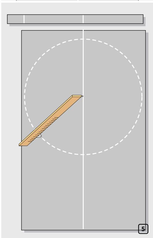
Начертите на материале окружность радиусом равным половине размера полученного при измерении криволинейной поверхности (рис. 5).
