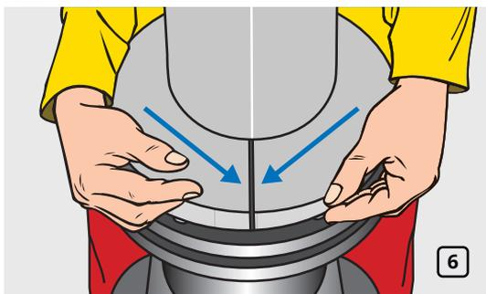
Установите кольца у внешних сторон каждого фланца, соедините стыки с помощью клея K-FLEX K-404 (рис. 6).
