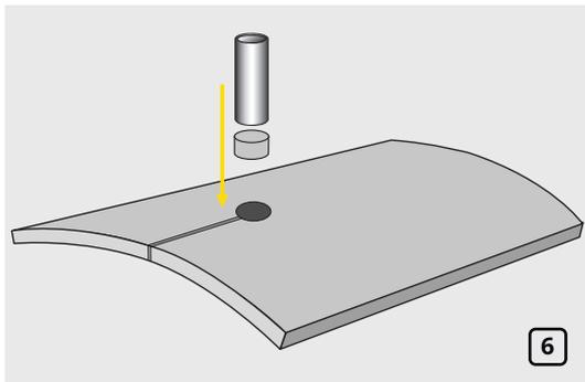
Выполните продольный разрез, как показано на рисунке. На его конце сделайте с помощью пробойника круглое отверстие диаметром равным диаметру ножки крана (рис. 6).
