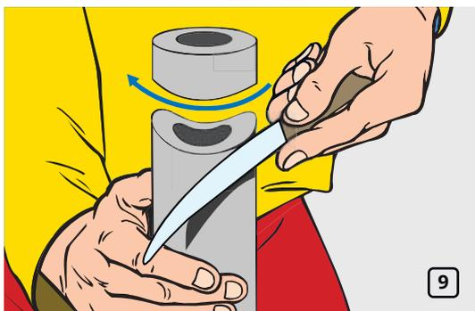
Возьмите фрагмент трубки K-FLEX заготовленной для монтажа примыкающей части на тройнике. Вырежьте на торце трубки U-образное углубление (рис. 9).
