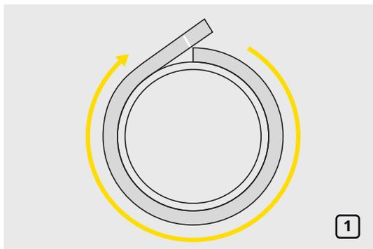
Точно измерьте длину окружности трубы с помощью полоски материала такой же толщины, как и применяемая изоляция. Пометьте мелом место нахлеста. Не растягивайте полоску при измерении (рис. 1).
