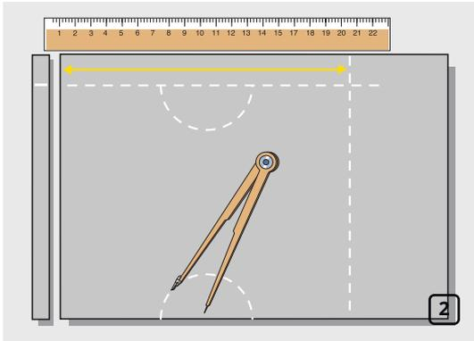
Нанесите полученные размеры на теплоизоляционный материал как показано на рисунке. Начертите с помощью циркуля две полуокружности радиусом равным половине диаметра вертикальной трубы бокового ответвления (рис. 2).
