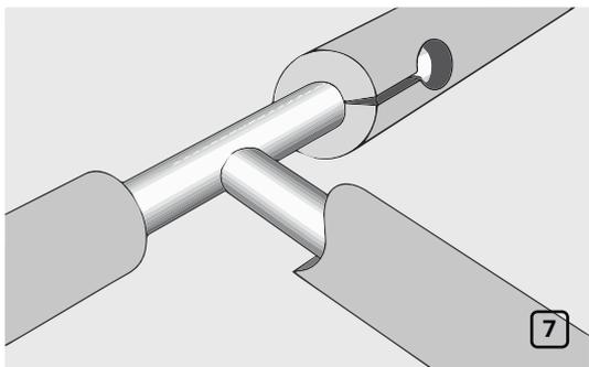
Для соединения трубок между собой необходимо нанести клей K-FLEX K-404 на торцы, затем соединить их и плотно прижать склеенные детали (рис. 4-5).
