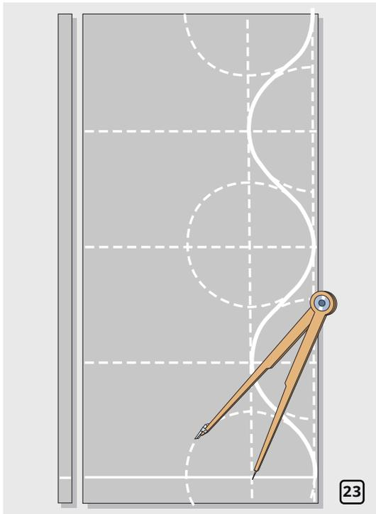
Используя разницу между длинами начерченных отрезков как радиус, проведите с помощью циркуля пять окружностей с центрами на концах этих отрезков. Проведите плавную кривую линию, соединяющую все дуги нарисованных окружностей как показано на чертеже (рис. 23).
