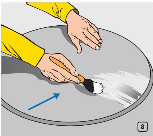
Промажьте крышку, или днище резервуара клеем K-FLEX K-404 (рис. 8).
