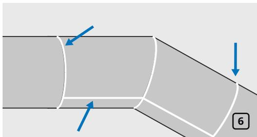
При необходимости на клеевые швы временно устанавливаются пластиковые зажимы K-FLEX. После высыхания клея все швы должны быть герметизированы самоклеящейся лентой в соответствии с рекомендациями.
