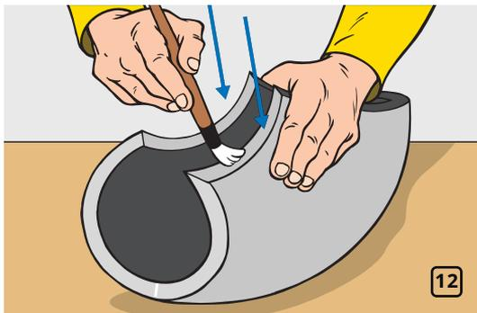
Нанесите клей вдоль внутренних краев детали изоляционного угла, подождите пока он подсохнет (рис. 12).
