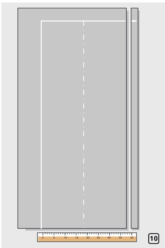
Нанесите полученные размеры на изоляционный лист K-FLEX и по середине линию как показано на рисунке (рис. 10).
