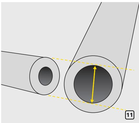
Возьмите изоляционную трубку с внутренним диаметром, равным внешнему диаметру примыкающей изоляции (рис. 11).
