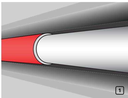
Смонтируйте теплоизоляционную трубку K-FLEX PE COMPACT соответствующего диаметра на трубопровод методом натяжения. Во избежание деформации теплоизоляционной трубки натяжение осуществляйте осторожно, не создавая излишнего давления (рис. 1).
