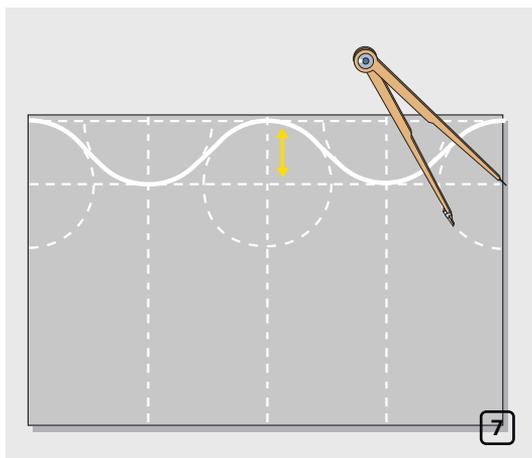
Разделите сторону вырезанной выкройки, которая соответствует длине окружности бокового ответвления на четыре равные части. Нанесите на выкройку размер горловины отвода, начертите с помощью циркуля пять окружностей с центрами как показано на чертеже, радиусом равным размеру горловины отвода. Проведите плавную кривую линию соединяющую все дуги нарисованных окружностей (рис. 7).
