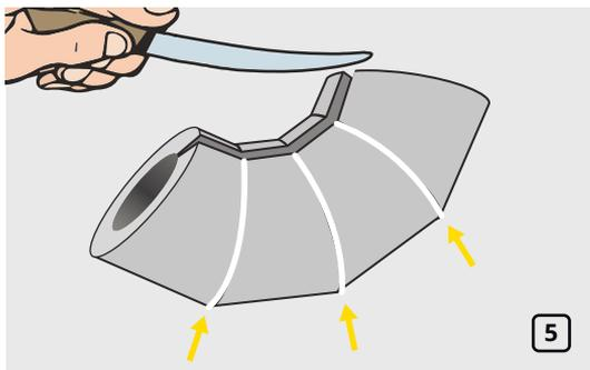
Разрежьте получившийся угол вдоль внутренней стороны (рис. 5).
