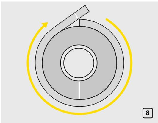
Определите длину окружности фланцев с помощью полоски материала той же толщины, что и применяемая изоляция (рис. 8).
