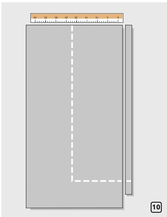
Нанесите полученные размеры на изоляционный лист (рис. 10).
