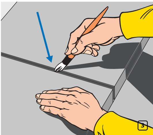
Склейте вместе края теплоизоляции с помощью клея K-FLEX K-404 (рис. 3).
