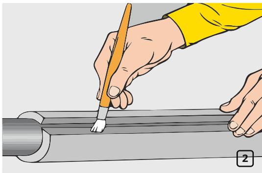
Расположить теплоизоляцию таким образом, чтобы края не соприкасались. Нанести клей K-FLEX K-404 тонким слоем на оба края (рис. 2).
