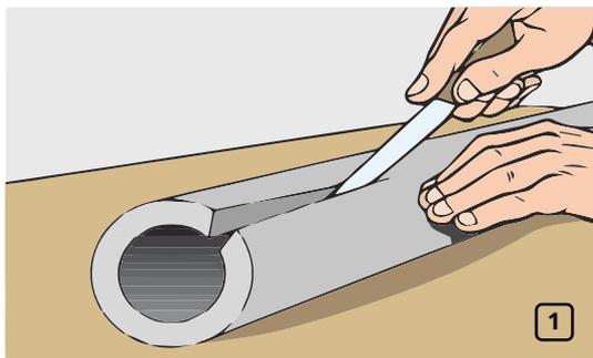
Для проведения монтажа необходимо продольно разрезать теплоизоляционную трубку K-FLEX (рис. 1).
