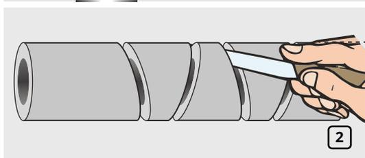
Используя столярное стусло, отрезать 3–5 сегментов теплоизоляционной трубки под равными углами, при этом сумма углов не должна превышать 90° (рис. 2-3).
