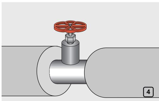
При монтаже на высокие краны сначала выполните изоляцию примыкающих к вентилю труб (рис. 4).
