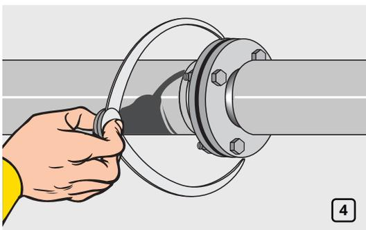
Измерьте диаметр фланцев. Для труб с хладоносителем рекомендуется заполнять пространство между фланцами материалом K-FLEX (рис. 4).
