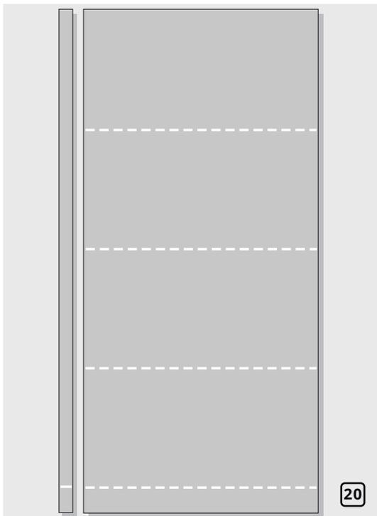
Перенесите полученное измерение на листовой материал. На отрезке листа теплоизоляции сделайте четыре разметки по результатам полученных измерений (рис. 20).
