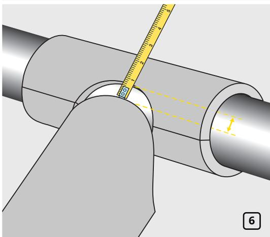
Положите изоляционный лист на боковое ответвление, придвиньте его вплотную к изоляции горизонтальной трубы. Измерьте горловину отвода (рис. 6).
