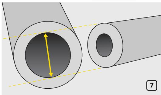
При монтаже изоляции на углы с разным диаметром сначала выполните изоляцию примыкающих к соединению труб меньшего диаметра. Возьмите изоляционную трубку с внутренним диаметром равным внешнему диаметру примыкающей изоляции (рис. 7).
