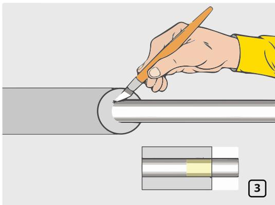
После установки зафиксировать теплоизоляционную трубку с помощью клея (рис. 3).
