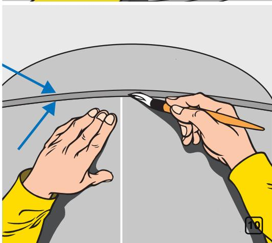
Проклейте шов между изоляцией стенок и крышки, или днища резервуара (рис. 10).
