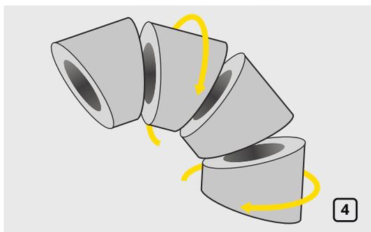
Разверните каждый второй сегмент на 180° так, чтобы образовался необходимый угол. Затем склейте все составные части теплоизоляционного угла между собой клеем K-FLEX K-404 (рис. 4).
