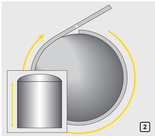
Измерьте периметр резервуара используя полосу материала K-FLEX той же толщины, что и применяемая изоляция, не растягивая полосу при измерении. Затем определите высоту стенок металлической емкости (рис. 2).
