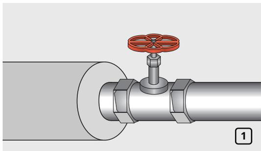
Небольшие вентили и запорные краны могут изолироваться с помощью трубок K-FLEX. Существуют различные способы изоляции вентилей, зависящие от высоты крана (рис. 1).
