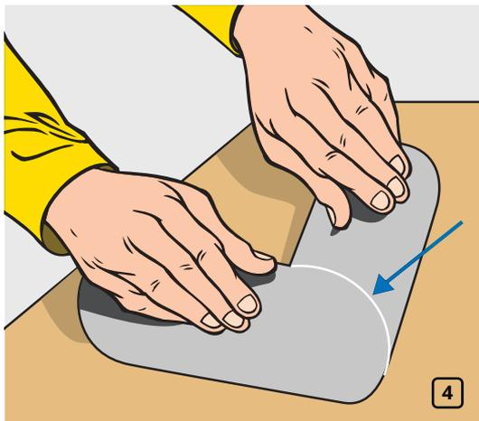
Равномерно нанесите клей K-FLEX K-404 на соединяемые части, затем соедините их (рис. 4).
