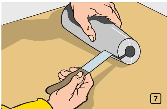
Сделайте продольный разрез вставки из теплоизоляции и установите его на трубопровод (рис. 7).
