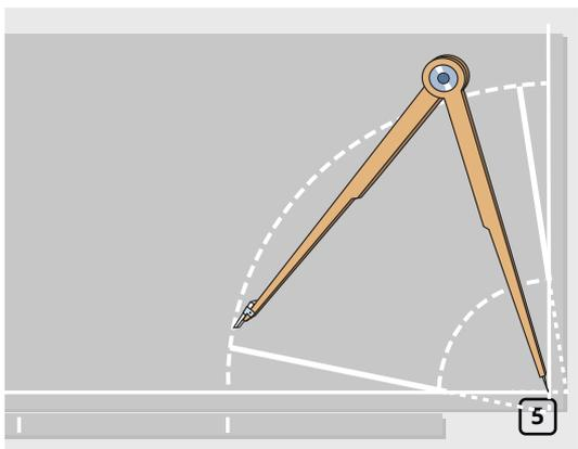
Перенесите этот размер на лист K-FLEX, отложив его от линии внутреннего радиуса изгиба трубопровода. Проведите с помощью циркуля вторую окружность из того же центра через отмеченную точку. На внешней окружности отложите от края  $1/6$  от ее длины и соедините линиями с краем внутренней окружности как показано на рисунке (рис. 5).
