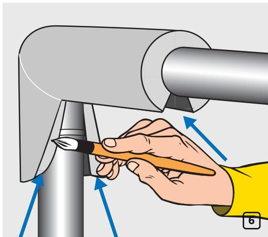
Оденьте угол на изгиб трубы и нанесите клей K-FLEX K-404 на оба края разреза (рис. 6).
