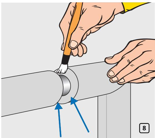
Приклейте края угла к трубе и к остальной изоляции (рис. 8).
