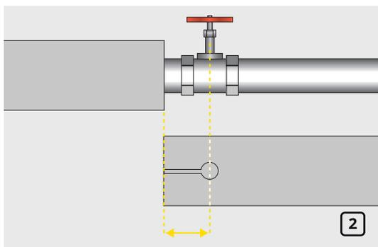
Разрежьте изоляционную трубку K-FLEX на расстояние достаточное для изоляции крана. На конце разреза выполните с помощью пробойника круглое отверстие диаметром равным диаметру ножки крана (рис. 2).
