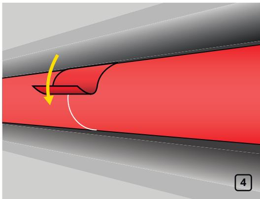
Проклейте швы лентой K-FLEX DUCT 1604H соответствующего цвета для герметизации соединений (рис. 4).
