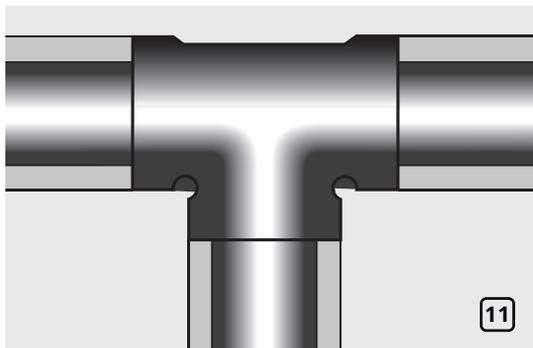
В случае, если Т-фитинг имеет больший диаметр, чем примыкающие к нему трубы, то сначала выполните изоляцию примыкающих к соединению труб меньшего диаметра. Вплотную придвиньте трубки K-FLEX к Т-фитингу и приклейте их внутреннюю поверхность к трубам (рис. 11).
