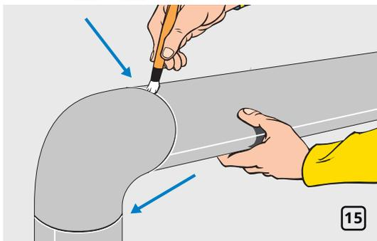
Приклейте края изоляционного угла к трубе и к остальной изоляции (рис. 15).
