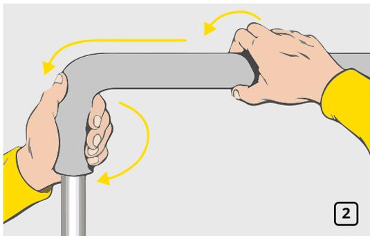
Плавно протянуть теплоизоляционную трубку, поворачивая ее по оси трубы. Не рекомендуется растягивать и деформировать материал (рис. 2).
