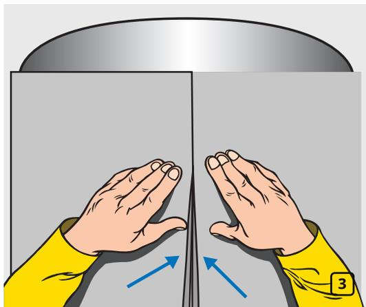
Перенесите полученные размеры на изоляцию K-FLEX и вырежьте заготовку. Нанесите клей K-FLEX K-404 на всю поверхность листа. Промажьте стенки резервуара клеем с помощью кисти. Нанесите клей на торцы листа, подлежащие склеиванию. После подсыхания клея установите лист на ёмкость, затем соедините его края и кратковременно сожмите (рис. 3).
