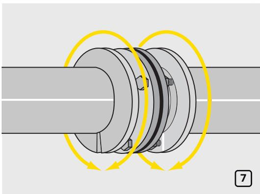
Установите кольца у наружных поверхностей каждого фланца, соедините их разрезанные концы с помощью клея K-FLEX K-404 (рис. 7).
