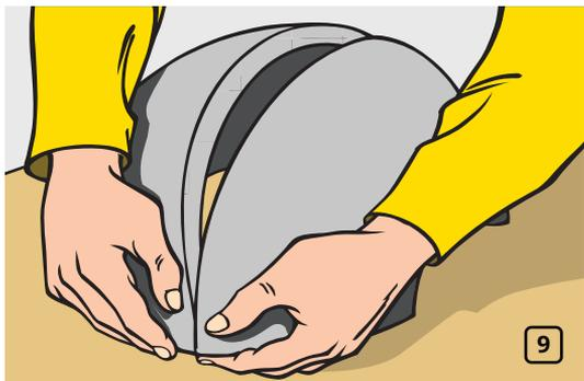
После подсыхания клея, прижмите две полусекции друг к другу сначала с одного, а затем с другого конца. Продолжите склейку шва двигаясь от краев к середине (рис. 9).
