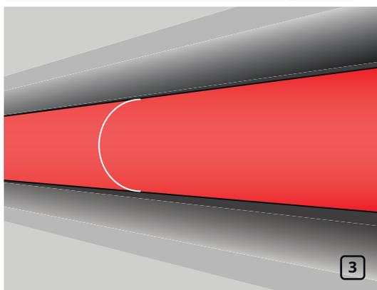
Смонтируйте следующую трубку на трубопровод, затем нанесите слой клея на ее торец. Когда клей подсохнет, соедините торцы теплоизоляционных трубок (рис. 3).
