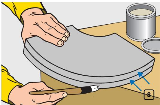
Совместите края двух полусекций изоляционного угла. Нанесите клей K-FLEX K-404 на края большого радиуса (рис. 8).
