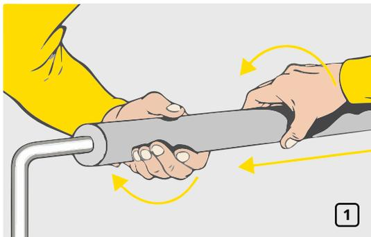
Не разрезая теплоизоляционной трубки K-FLEX, натянуть ее на открытый конец трубы и переместить вдоль трубы до места установки (рис. 1).
