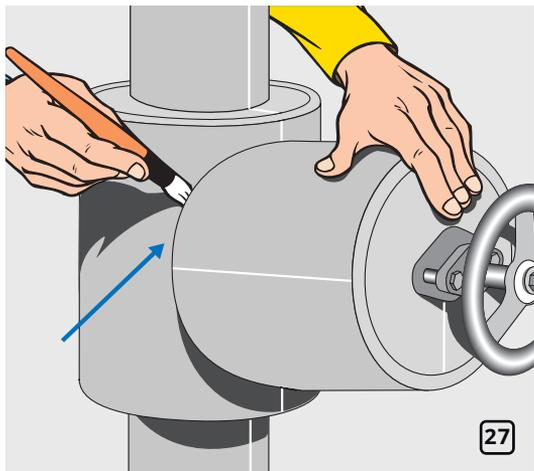
Приклейте изоляцию горловины вентиля к уже смонтированной изоляции корпуса вентиля (рис. 27).
