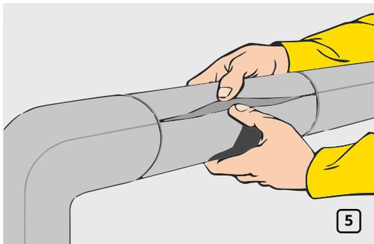
При необходимости на клеевые швы временно устанавливаются пластиковые зажимы K-FLEX. После высыхания клея все швы должны быть герметизированы самоклеящейся лентой в соответствии с рекомендациями.
