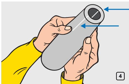
Нанесите клей K-FLEX K-404 на края V-образных вырезов. Дайте клею подсохнуть, затем соедините края и сильно сожмите на очень короткое время (рис. 4).
