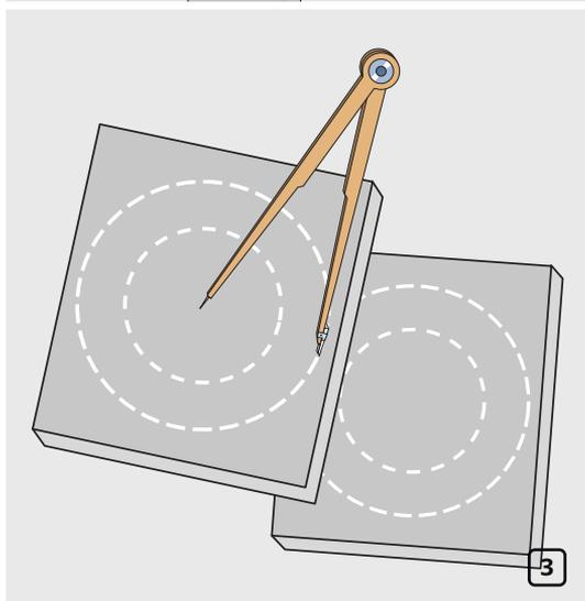
По результатам измерений вычислите радиусы изоляционных колец. Прочертите с помощью циркуля внешнюю и внутреннюю окружности колец на двух различных кусках материала K-FLEX соответствующей толщины (рис. 3).
