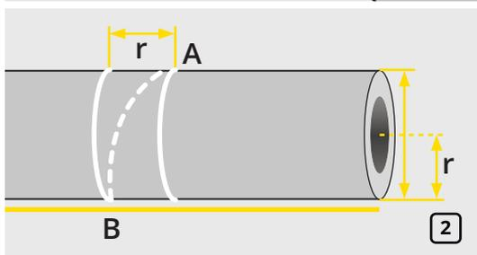
По центру трубки нанести две параллельные линии, расстояние между которыми должно равняться внешнему радиусу теплоизоляционной трубки. На параллельных линиях в противоположных вершинах трубки отметить точки А и В, соединить эти точки линией (рис. 2).
