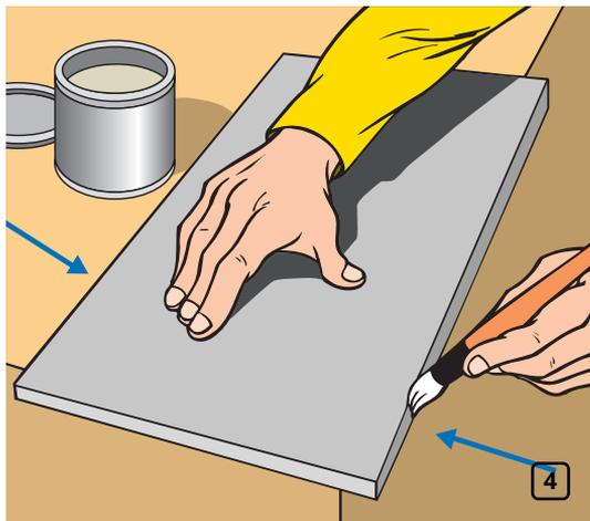
Нанесите равномерный тонкий слой клея K-FLEX K-404 на подлежащие склеиванию торцы листовой изоляции (рис. 4).
