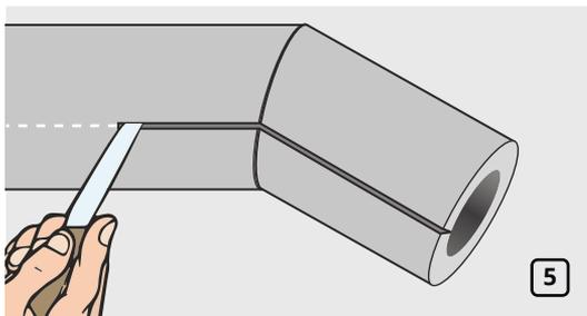
Прорезать трубки вдоль внутренней линии угла и установить на трубу, после проклеить поперечные и продольные швы используя клей K-FLEX K-404 (рис. 5-6).
