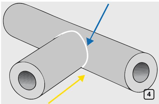
Затем соединить части трубок и склеить при помощи клея K-FLEX K-404 (рис. 4).
