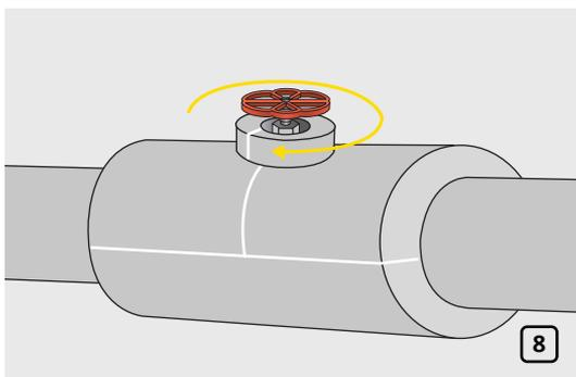
Тщательно склейте разрезы и места соединения с примыкающими секциями клеем K-FLEX K-404. При необходимости дополнительно изолируйте торчащую ножку (рис. 8).
