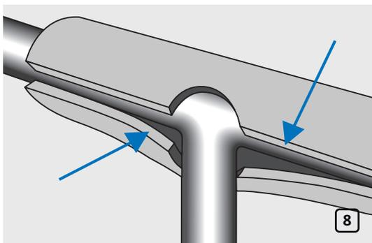
Разрежьте трубку вдоль так, чтобы разрез пришелся по середине выполненного отверстия. Наденьте изоляцию на трубопровод, пропуская боковое ответвление в отверстие. Склейте трубку (рис. 8).
