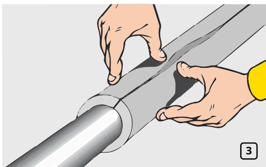
Дать клею подсохнуть «до отлипа», затем плотно сжать края трубки (не более 10 сек.) (рис. 3).
