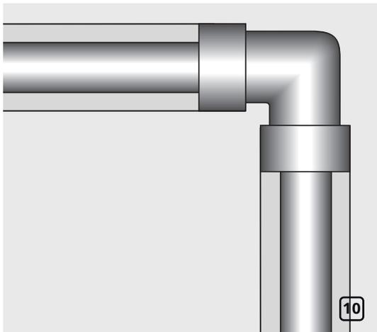
При монтаже изоляции на углы с разным диаметром в начале выполните изоляцию примыкающих к соединению труб меньшего диаметра. Вплотную придвиньте трубки K-FLEX к фитингу и приклейте их внутреннюю поверхность к трубе (рис. 10).
