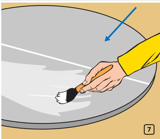
Нанесите клей K-FLEX K-404 на всю поверхность вырезанной детали (рис. 7).
