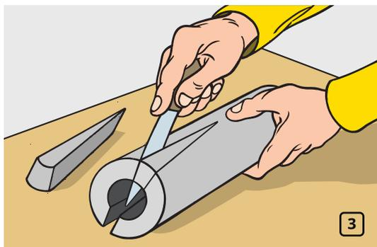
Вырежьте с одной стороны трубки два V-образных клина напротив друг друга таким образом, что бы обеспечить плотное прилегание теплоизоляционной трубки к трубе малого диаметра (рис. 3).
