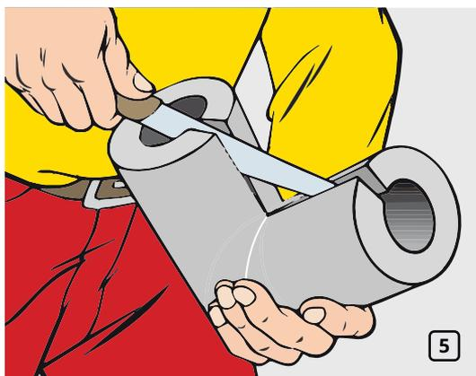
После того, как клей просохнет, аккуратно прорежьте изоляционный угол вдоль внутренней стороны (рис. 5).
