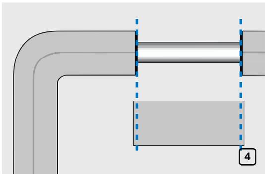
При выполнении соединения двух смонтированных участков теплоизоляции необходимо вырезать фрагмент теплоизоляционной трубки соответствующей толщины и диаметром с допуском по длине +2 мм от длины вставки (рис. 4-5).
