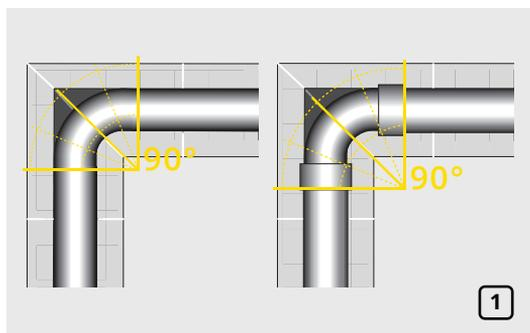
Теплоизоляция углов (отводов) 90° осуществляется путем соединения двух линейных участков, обрезанных под углом в 45° (рис. 1)
