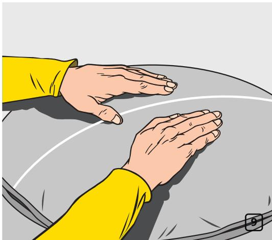
Когда клей подсохнет, установите изоляционный круг на крышке резервуара. Аккуратно прижмите изоляцию к поверхности, начинайте работу с центра и постепенно перемещайтесь к краям заготовки (рис. 9).
