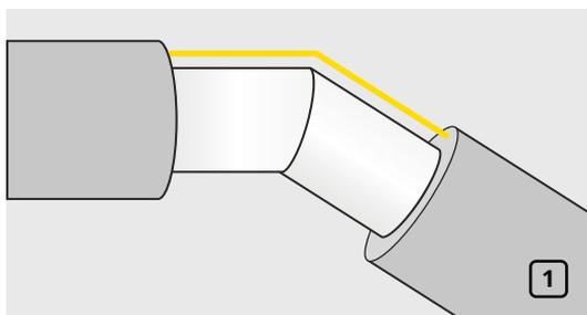
Для монтажа углов более 90° необходимо отрезать фрагмент теплоизоляционной трубки. Длина фрагмента должна быть равной сумме длин катетов, образующих данный угол (рис. 1).
