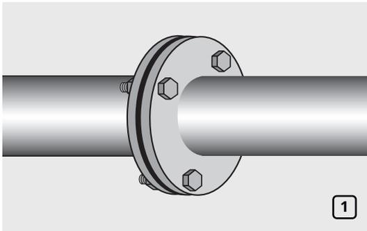
При выполнении изоляции фланцев необходимо точно вырезать два кольца из теплоизоляционного материала K-FLEX (рис. 1).
