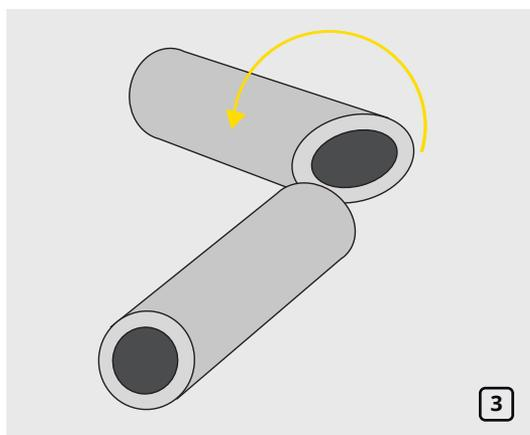
Разверните одну часть трубки относительно другой так, чтобы образовался прямой угол (рис. 3).
