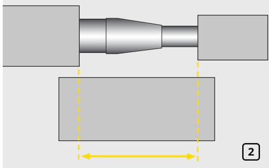
Возьмите отрезок теплоизоляции для трубы большего диаметра длиной превышающий участок неизолированной поверхности (рис. 2).
