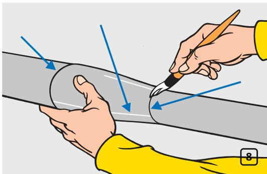
Нанесите клей на оба края разреза. Дайте клею подсохнуть, затем соедините края и кратковременно сильно сожмите. Приклейте края вставки к изоляции трубопровода (рис. 8).
