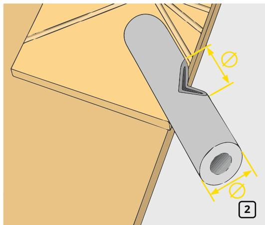
Трубку «примыкания» обрезать под двойным углом  $45^\circ$  (рис. 3).
