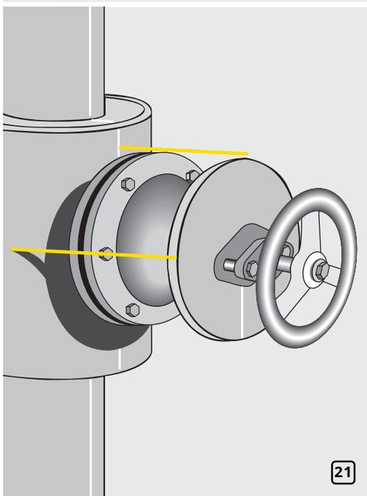
Определите минимальную и максимальную глубину горловины вентиля с учетом толщины изоляции торцевого фланца (рис. 21).
