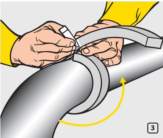
Измерьте длину окружности трубы, используя полоску материала той же толщины, что и применяемая изоляция. Не растягивайте полоску при измерении (рис. 3).
