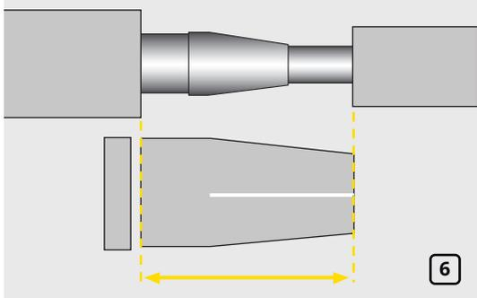
Точно измерьте расстояние оставленное между ранее изолированными секциями. Подрежьте изоляционный конус со стороны большого диаметра до необходимой длины с учетом небольших припусков длиной 2 мм (рис. 6).
