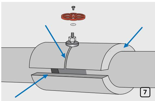
Снимите рукоятку крана, если это возможно, перед началом работ по монтажу изоляции вентиля. Установите изготовленную деталь на вентиль, продев ножку крана в круглое отверстие. Убедитесь, что обеспечивается нахлест установленного материала поверх изоляции примыкающих труб (рис. 7).
