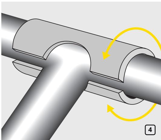
После того, как клей подсохнет, оберните изоляцию вокруг трубопровода, пропустив боковое ответвление в предназначенное для него отверстие. Соедините края материала (рис. 4).
