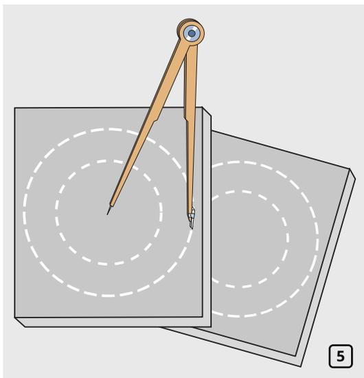
По результатам измерений вычислите радиусы изоляционных колец. Прочертите с помощью циркуля внешнюю и внутреннюю окружности колец на двух различных кусках материала K-FLEX соответствующей толщины (рис. 5).
