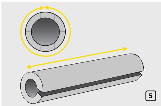
Возьмите отрезок трубки большего диаметра с учетом нахлеста на ранее изолированный участок. Разрежьте его вдоль (рис. 5).
