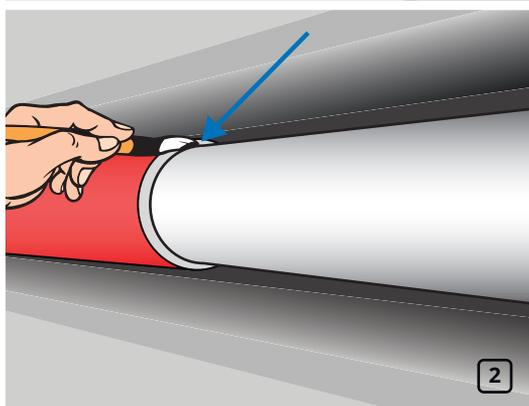
Нанесите тонкий, ровный слой клея K-FLEX K-404 на торец теплоизоляционной трубки (рис. 2).
