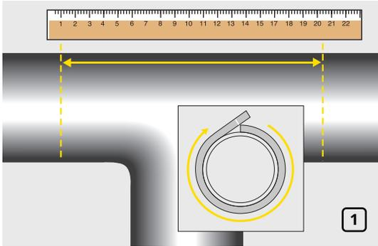
Определите с помощью линейки длину листового материала K-FLEX, необходимую для выполнения изоляции соединения. Измерьте длину окружности горизонтальной трубы, используя полосу материала K-FLEX той же толщины, что и применяемая изоляция. Не растягивайте полосу при измерении (рис. 1).
