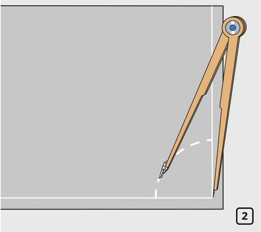
Проведите на изоляционном материале K-FLEX две перпендикулярные прямые линии. Отступ от края листа должен соответствовать толщине теплоизоляции. Начертите с помощью циркуля контур внутреннего радиуса изгиба трубопровода с центром в точке пересечения прямых (рис. 2).
