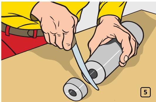
После того как клей подсохнет, аккуратно отрежьте изоляционный конус с узкой стороны так, чтобы полученный при этом диаметр соответствовал диаметру изоляции меньшего трубопровода (рис. 5).
