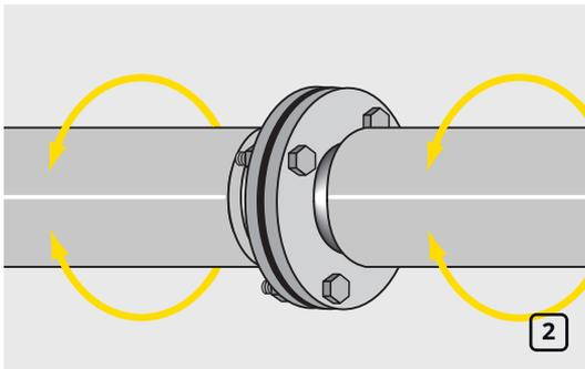
Изолируйте трубы, примыкающие к фланцам вплотную придвинув материал (рис. 2).
