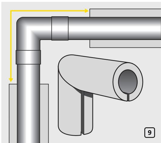
Если участки изоляции, подходящие к углу смонтированы, длина угловой секции должна быть точно измерена с учетом припусков в 2 мм (рис. 9).
