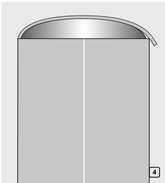
Для изоляции крышки или дна резервуара необходимо измерить криволинейную поверхность. Используйте полоску материала K-FLEX той же толщины, что и применяемая изоляция, не растягивайте ее при измерении. В случае, если изолируемая площадь имеет большие размеры, используйте несколько листов изоляции (рис. 4).
