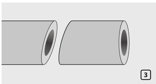
Разрезать теплоизоляционную трубку K-FLEX по линии А-В (рис. 3).
