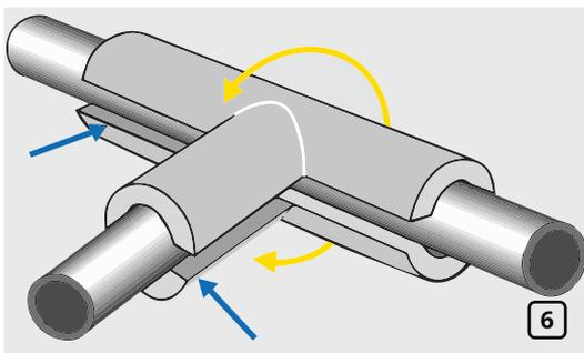
Оденьте тройник на трубопровод и нанесите клей на оба края разреза. Дайте клею подсохнуть, затем соедините края и сильно сожмите на очень короткое время. Приклейте края тройника к трубам и к остальной изоляции. В случае, если участки изоляции, подходящие к тройнику уже окончательно смонтированы, длина Т-образной секции должна быть точно измерена с учетом небольших припусков длиной 2 мм (рис. 6).
