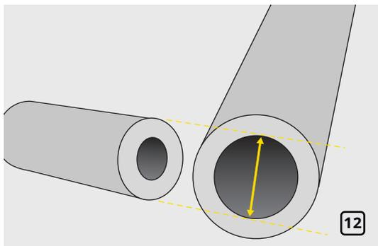
Возьмите изоляционную трубку с внутренним диаметром равным внешнему диаметру примыкающей изоляции. Изготовьте изоляционный тройник, обеспечивающей нахлест 25 мм во всех направлениях (рис. 12).
