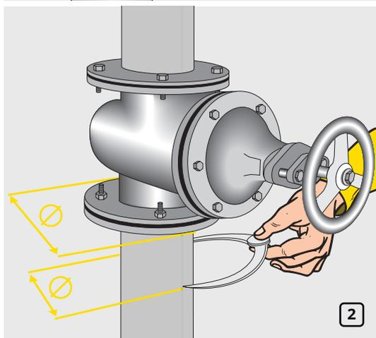
Измерьте диаметр трубы вместе с изоляцией и диаметр фланцев (рис. 2).
