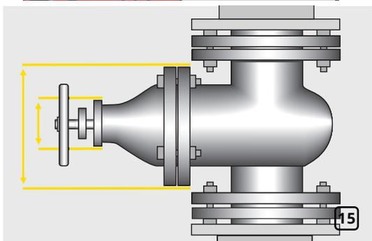
Измерьте диаметр торцевых фланцев, определите форму и размер пластины через которую должно устанавливаться изоляционное кольцо (рис. 15).
