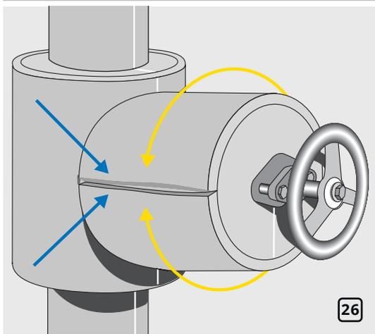
Нанесите клей K-FLEX K-404 на края, которые необходимо склеить. Подождите пока клей подсохнет. Оберните изготовленную деталь вокруг горловины вентиля, соедините проклеенные концы материала K-FLEX и кратковременно сожмите их (рис. 26).
