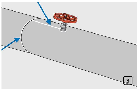
Установите трубку в нужное место. Тщательно склейте разрез и место соединения с соседней секцией (рис. 3).
