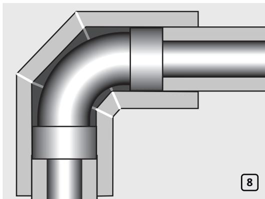
Изготовьте сегментный теплоизоляционный угол и установите его на фитинг. Длина угла должна обеспечивать нахлест 25 мм на ранее смонтированную изоляцию (рис. 8).
