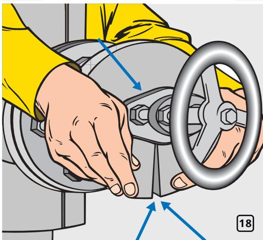
Нанесите клей K-FLEX K-404 на место стыка. После того как клей подсохнет, установите деталь на горловину вентиля и соедините вместе проклеенные концы материала. Приклейте внутренние края изоляционного кольца к пластине вентиля (рис. 18).
