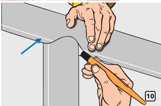
Оденьте изоляцию на боковое ответвление. Присоедините трубку с вырезанным торцом к изоляции трубопровода, как показано на рисунке. Соедините их между собой с помощью клея K-FLEX K-404 (рис. 10).
