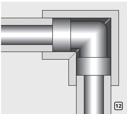
Изготовьте изоляционный угол длиной, обеспечивающей нахлест 25 мм, установите его на фитинг (рис. 12).
