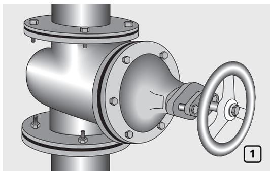
Сначала изолируйте трубы примыкающие к вентилю, вплотную придвинув материал K-FLEX (рис. 1).
