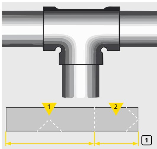
Для монтажа Т-образного соединения необходимо отрезать два фрагмента теплоизоляционной трубки K-FLEX. Длина 1-го должна быть равна длине основания тройника («трубка-основания»), длина 2-го равна длине примыкающей части в тройнике («трубка-примыкания») (рис. 1).
