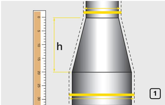
Измерьте высоту перехода включая сварные швы (рис. 1).
