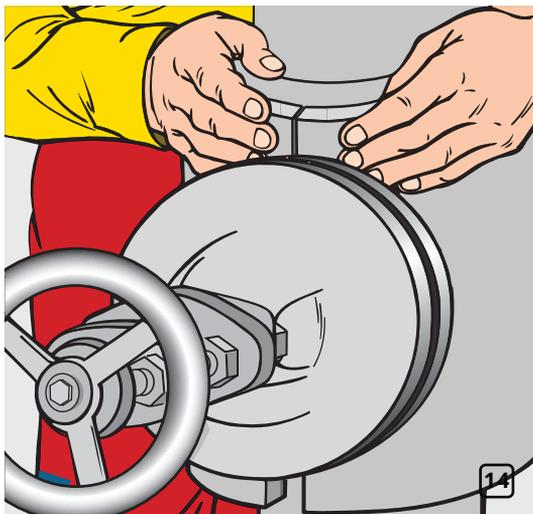
Подождите пока клей подсохнет, оберните вырезанную деталь вокруг фланцев вентиля, пропустив его горловину в полученное отверстие. Соедините края материала и кратковременно сожмите (рис. 14).
