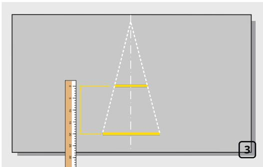
Проведите на материале центральную линию. Перенесите все полученные измерения (максимальный и минимальный диаметр соединяемых труб, высоту переходника) на лист материала, используя центральную линию. Проведите линии через концы отрезков до пересечения с центральной линией как показано на рисунке (рис. 3).
