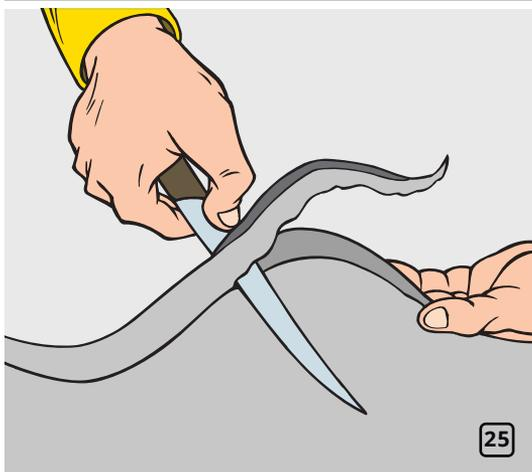
Подрежьте под углом кромки выпуклых участков кривой линии по направлению к внутренней поверхности изоляции K-FLEX (рис. 25).
