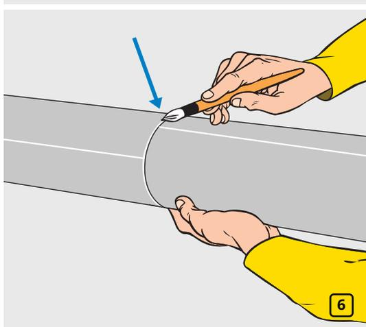
Тщательно приклейте края к ранее смонтированному материалу. Обеспечьте совпадение продольных швов соседних секций изоляции, поворачивая ранее смонтированные трубки вокруг трубопровода до их окончательного соединения (рис. 6).
