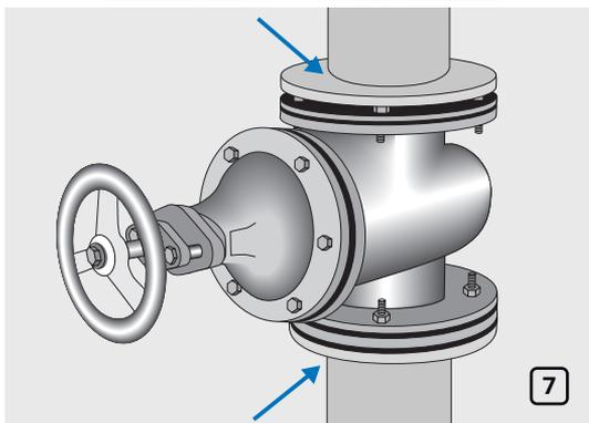
Тщательно проклейте места соединения обоих колец с изоляцией на трубопровод (рис. 7).
