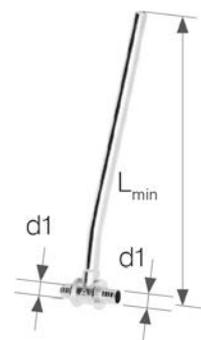
**тройник латунный Push с трубкой Cu Ø15, никелированный,**
