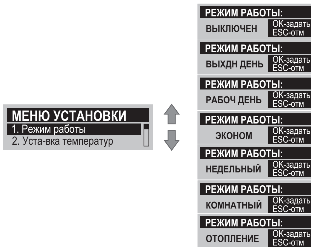
Рисунок 27. Отображение на экране режимов работы прибора.
