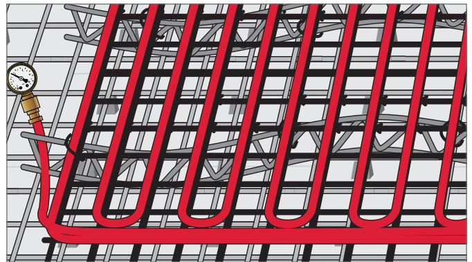
Рис. 8-28 Шаг 4: Произвести испытания сжатым воздухом
