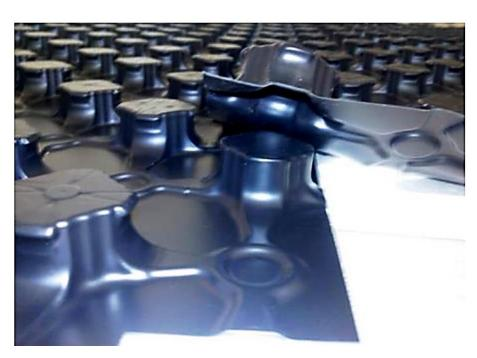
Пленочное покрытие обеспечивает надежную гидроизоляцию. Благодаря рельефу трубки возвышаются над поверхностью плиты, увеличивается контактная поверхность трубки с бетоном стяжки.
