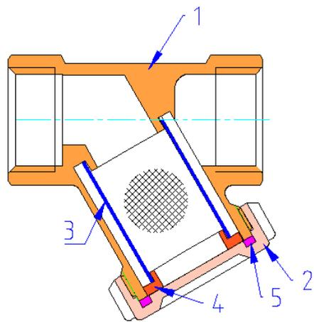
Фильтр состоит из корпуса 1, заглушки 2, фильтроэлемента 3, центрирующей втулки 4 и прокладки 5. Корпус и заглушка выполнены из горячепрессованной, никелированной латуни марки CW617N.
