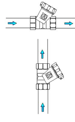
5.2. При направлении потока снизу-вверх, необходимо выполнить горизонтальный участок для правильной установки фильтра, в противном случае установка фильтра приведет к засорению нижнего отвода (угольника или тройника) трубопровода. Если горизонтальный участок выполнить не представляется возможным, следует использовать универсальный фильтр VT.386.
